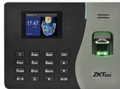
**Control de Asistencia IP** mediante Huella Digital y Tarjeta ID Pantalla de TFT de 2.8" TFT / Capacidad de 500 huellas de / 500 tarjetas / 50,000 registros / Puertos TCP/IP y USB Host / Alarma, mensajes en pantalla, código de trabajo, informes SSR Excel, copia de seguridad en tiempo real, entrada T9, ID de 9 dígitos. Software: ZKTime.Net Lite (Gratis) / ZKTime.Net 3.0 (Licencia)
