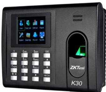
**Control de Asistencia IP y Acceso Básico** con Huella Digital y Tarjeta ID Pantalla de 2.8" TFT / Capacidad de 1,000 huellas / 1,000 tarjetas / 80,000 registros / Puertos TCP/IP y USB Host / Batería incorporada / Alarma, mensajes en pantalla, código de trabajo, informes SSR Excel, copia de seguridad en tiempo real, entrada T9, ID de 9 dígitos. Software: ZKTime.Net Lite (Gratis) / ZKTime.Net 3.0 (Licencia).
