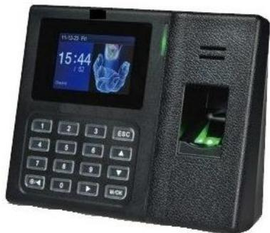
**CONTROL DE ASISTENCIA:** Huella Digital y/o Clave | Interior | Conexión sólo USB Capacidad de Huellas: 500 • Tarjetas: 500 • Transacciones: 50,000 • Pantalla TFT 3", C/reporte USB (Host y Cleinte) • Puerto USB: carga y descarga de Datos • Alim: 5Vdc/2A, Incluye: Fuente 220V.
