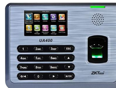
**CONTROL DE ASISTENCIA BIOMETRICO:** FACIAL Y/O HUELLA DIGITAL Y/O TARJETA | TCP/IP, USB, RS-485 | INTERIOR. Capacidad de Rostros: 1,200 • Capacidad de Huellas: 1,500 • Tarjetas: 2,000 • Lector RFID: EM Marín 125 KHz • Transacciones: 100,000 • Conexiones: cerradura eléctrica, botón de salida • Pantalla TFT 2.8". • Puertos: RS232/RS485, TCP/IP, USB (host) • Alimentación: 12Vdc/1.5A • Incluye fuente 220Vac.
