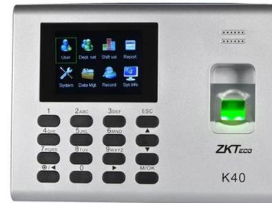
**Control de Asistencia IP por Huella Digital. Pantalla de 3" TFT / Capacidad de 3,000 huellas / 100,000 registros / Puertos TCP/IP, RS485, USB host / Código de Trabajo, SMS, DLST, Timbre Programado, Búsqueda Self-Service, Cambio Automático de Estado. Soporta ADMS**
