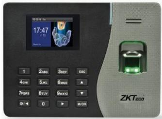
**CONTROL DE ACCESO & ASISTENCIA: HUELLA DIGITAL Y/O TARJETA Y/O CLAVE | Puertos: TCP/IP, USB | Uso INTERIOR. Capacidad de Huellas: 500 • Capacidad de Tarjetas RFID: 500 • Lector RFID: EM Marín 125 KHz • Transacciones: 50,000 • Pantalla TFT 2.8" • Conexiones: cerradura eléctrica, botón de salida, sensor de puerta**
